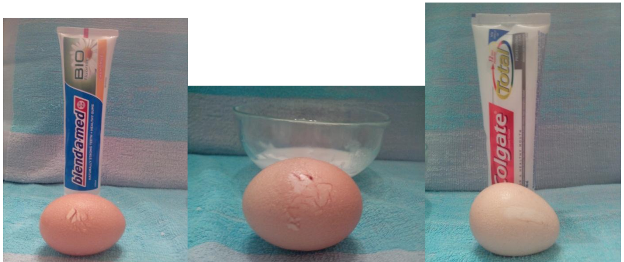
Яичные скорлупы через 15 минут после обработки 9% раствором уксусной КИСЛОТЫ
